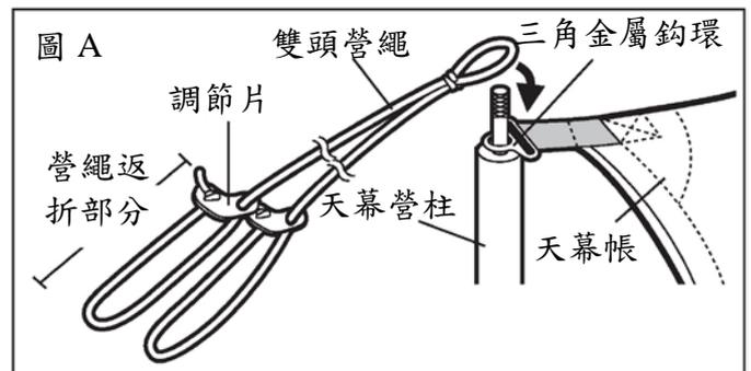
3) 撐起兩支天幕營柱，將已分別打上結的雙頭營繩掛在相對於天幕帳稜線的外側，以天幕營柱為中心，左右各分別拉開 45°，在該位置上釘入營釘〔圖 B〕。
